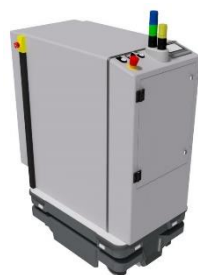
Braun-FTS-Aufbau für den Transport von Traystapeln
